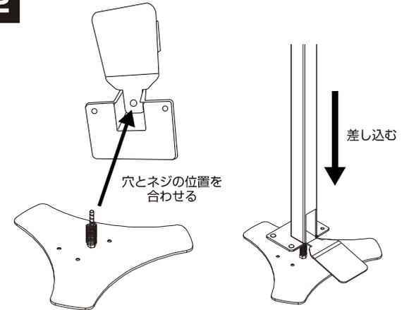
支柱固定用長ネジの上部からスプリングを入れ、支柱底面の穴にネジを差し込んでください。
