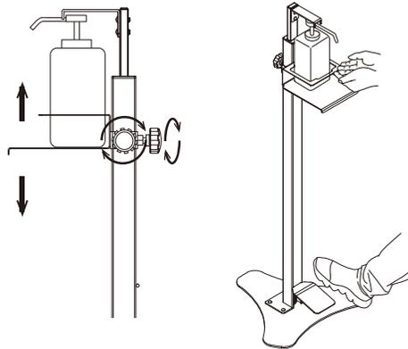
トレーに消毒液ポンプを置き、ポンプの上部が押し板に軽く当たる程度までトレーを上にあげて、後方(背面)および右側面の高さ調整ネジを締め固定してください。足元のペダルを踏むことで、手元のボトルから薬液を吐出します。
