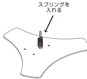
台座の中心に立っている支柱固定用長ネジにスプリングを入れます。
