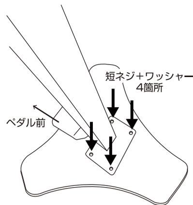
上図の向きで台座と支柱のネジ穴を合わせ、台座固定用短ネジとワッシャーを付属の六角スパナ中で4箇所をしっかりと締めて固定します。
