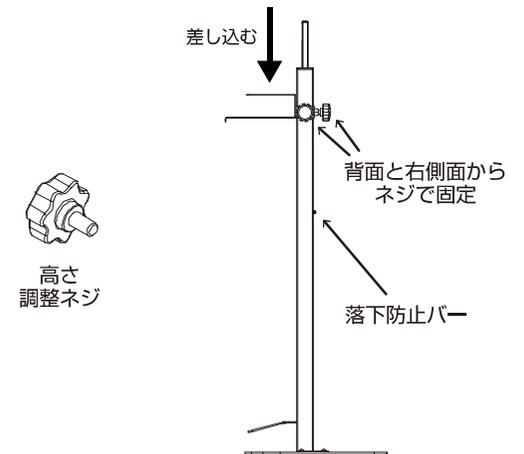
支柱上部からトレーを図の様に差し込み、後方(背面)および右側面の高さ調整ネジで締めます。
