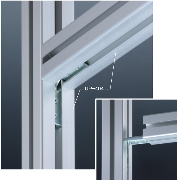
[位置決めクッションなし (UJ-40,30,43)] 止めねじはUボール同士に隙間が 空かないように調整しながらねじ を締め付けてください。
