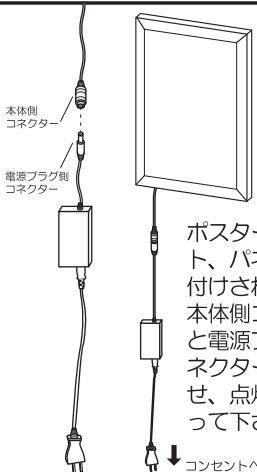
ポスター等のセット、パネルを取り付けされる前に、本体側コネクターと電源プラグ側コネクターを接続させ、点灯確認を行って下さい。
