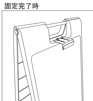
本体正面側に取付金具Aが飛び出るようになります。
