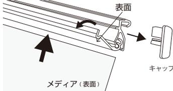
ずれないように気をつけながらロックをしてください。左右のキャップを取付けてください
