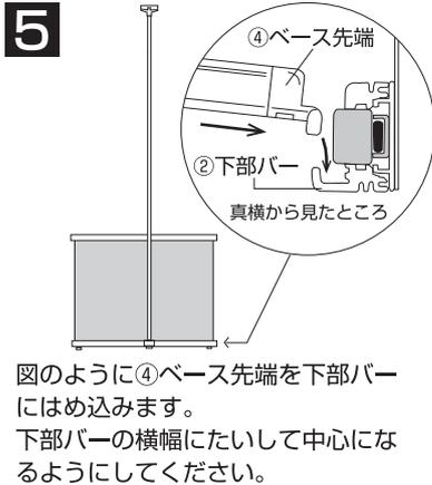
図のように④ベース先端を下部バーにはめ込みます。下部バーの横幅にたいして中心になるようにしてください。
