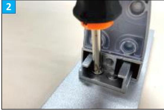
プラスドライバーで、ホルダーを固定しているネジを外します。
