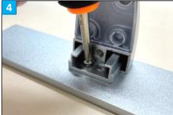
プラスドライバーでネジを締め、外したホルダーの片側を組み付けて下さい。
