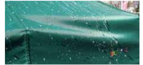
表面は撥水加工、裏面にも防水加工を施し、ダブルで雨の進入を軽減します。
