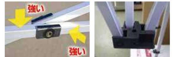
テントの風加重は斜め・横風を多く受けます。弊社のトラスバーは横加重に弱い形状の長方形より、縦・横に強い正方形の形状をしており、フレームジョイント箇所は予期せぬ力が加わります。「かんたんてんと3」は大きく頑丈なグラスファイバー+ナイロン6化合物樹脂を採用しております。
