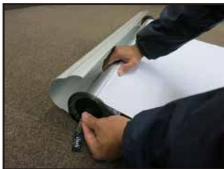
右手でロール部を押さえ、ゆっくりロックピンを抜きます。ロックピンを抜くとバネの力が働きますが、右手でしっかり阻止します。
