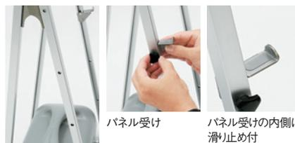
側辺の穴にパネル受けをつまみネジで取り付けれます。取り付け位置は、パネルのサイズに合わせて6段階に調整できます。
