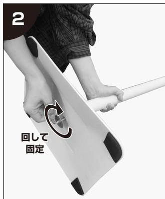
② 角型ベースの裏側から①で外した丸ワッシャーと L 字ボルトを差し込み、ポールの下部を合わせ、L 字ボルトを回して固定します。
