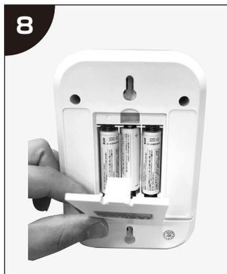
⑧ 温度計を電池式でご使用いただく場合、単 3 電池 3 本をセットします。
