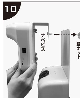
⑩ 温度計を取りつけた⑨のこの字プレートを、ナベビスと蝶ナットで取り付けトレイに固定します。
