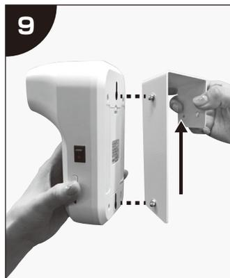
⑨ 温度計背面の上下の引掛け部分に、⑦でセットした皿ビス部分を下の穴から上の穴にスライドさせながら引っ掛け、蝶ナットをきちんと締めて固定します。
