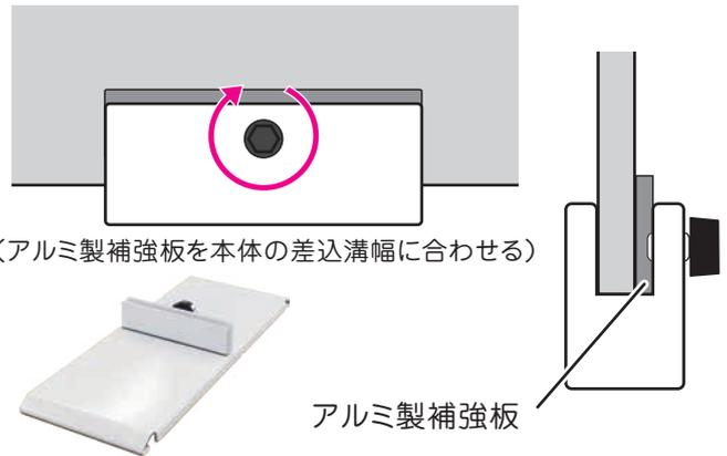
(アルミ製補強板を本体の差込溝幅に合わせる)
