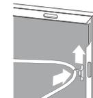
吊りを穴に差し込み、上にスライドして固定します。
