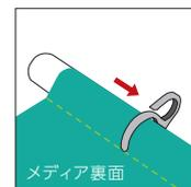
2. メディアにバーを通し、フックをその上からバーに沿うように入れ、バーに引っ掛け施工完了。
