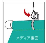
3. 引っ掛ける部分を壁面側にし、ワイヤーをフックに引っ掛け施工完了。
