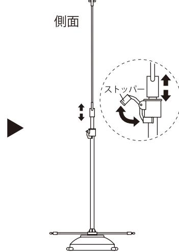
①ウォーターウェイト上部に付いているキャップを外して注水してから、確実にキャップを締めます。キャップの側面にある穴に下部バーを差し込みます。
