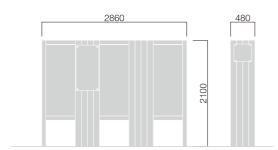
支柱:高強度アルミ押出形材、ご指定色塗装仕上パネル:透明アクリル、片面マットアルミ平板2t、ご指定色塗装仕上
