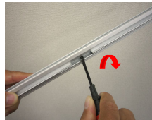
②バーの中央凹み場所にドライバーで開ける。
