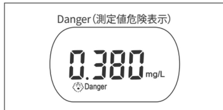
※ 測定結果が「0.250mg/L以上」の時は、表示部に「Danger」と表示され、Cautionより大きい警報音が鳴ります。(警告音を止めるには、電源ボタンを長押しして電源をオフにしてください。)
