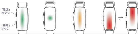
※ 警告のバイブレーションを一時的に消すには「機能」ボタンを短押し、警告アラートを消すには「電源」ボタンと「機能」ボタンを長押してリセット
