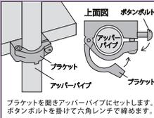
HPシリーズの基本構成は、突っ張りのアップパイプにブラケットを取り付けるだけ。プラスのドライバー一つで組立可能です。シンプルな構成なゆえに、柔軟なレイアウトにご対応できます。
