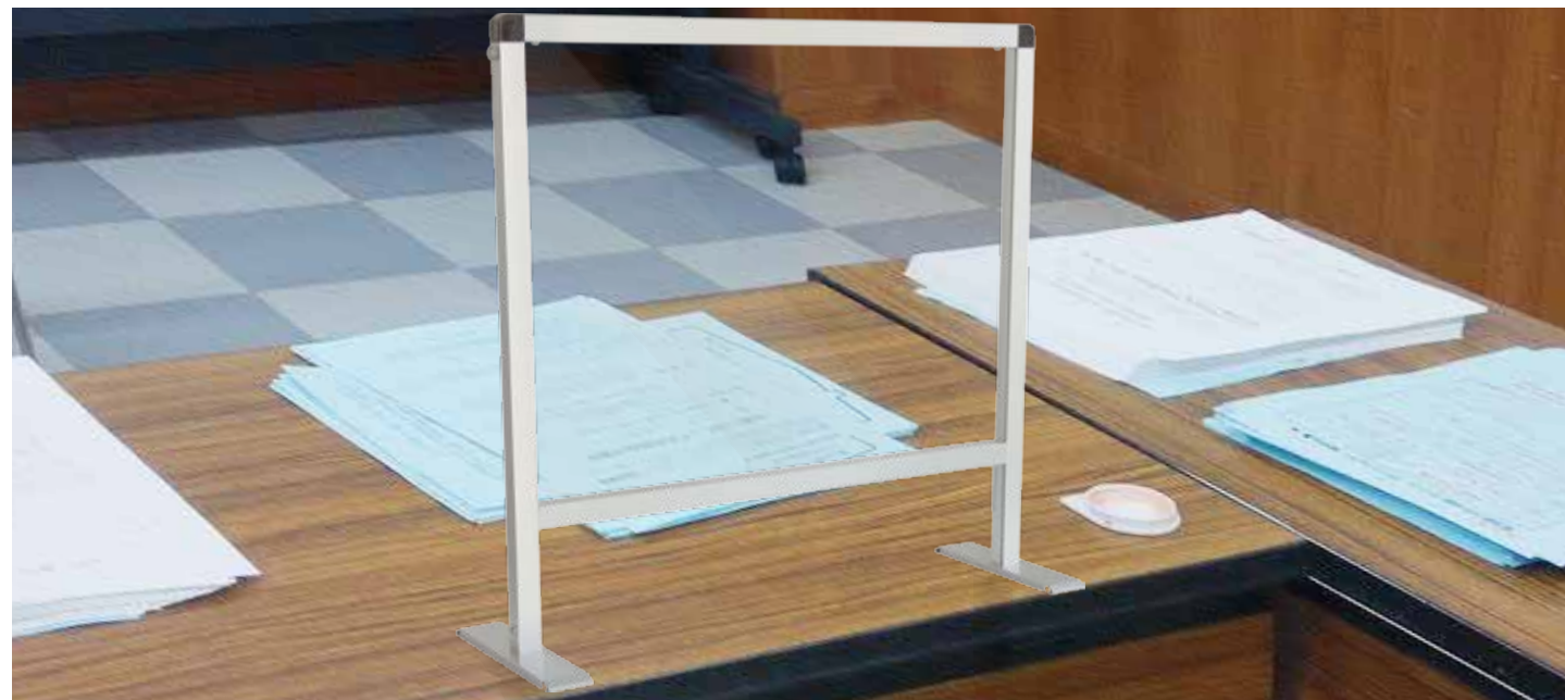
●パネルフレーム=22mm×25mmアルミ押し出し材/アルマイト仕上げ(シルバー/ブラック) ●アクリル板/塩ビ板(透明)=厚さ1.5mm~1.8mm ●脚部=材質:スチール鋼板(SPHC) 表面処理:焼付け塗装(シルバー/ブラック) サイズ:W50×220mm
