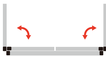
前面アクリル部分にピッタリ重なる サイドアクリル 50mm幅の隙間に収納OK
