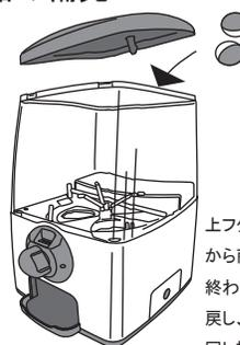
上フタが外れたら上から商品を投入し、終わったら上フタを元に戻し、カギをCLOSE方向に回し施錠します。
