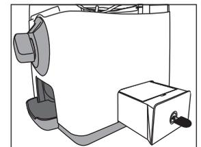
引き出しを抜き出し、コインを回収します。
