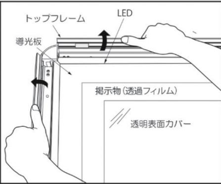
フレーム4辺を手で開きます。表面カバーがセットされているので外してから掲示物を導光板の上にセットし、表面カバーを上からセット後フレームを閉じて完了です。
