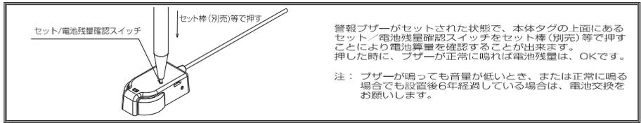
警報ブザーがセットされた状態で、本体タグの上面にあるセット/電池残量確認スイッチをセット棒（別売）等で押すことにより電池残量を確認することが出来ます。押した時に、ブザーが正常に鳴れば電池残量は、OKです。
