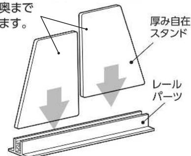
②パネルの厚みに合わせて隙間の幅を調節できます。
