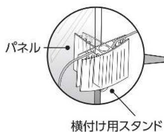
パネルの切れ込み位置に合わせて厚み自在スタンドを取り付けます。
