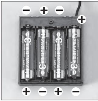
電池ボックスの裏フタを開け、単3乾電池を4本、セットします。※プラスマイナスの向きに注意してください。
