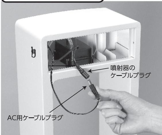
AC用ケーブルプラグを引き出し噴射器のプラグに接続します(左図)。
