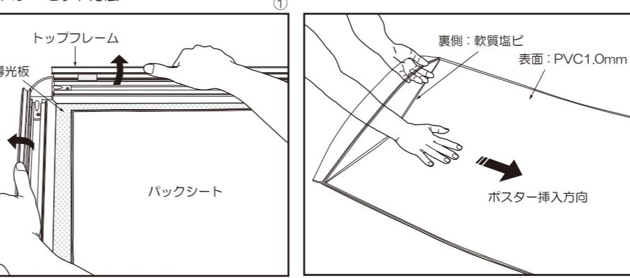
フレームを4辺手で開きます。防水電飾用パックシートがセットされているので外します。開閉時に指を挟まない様にお気をつけ下さい。
