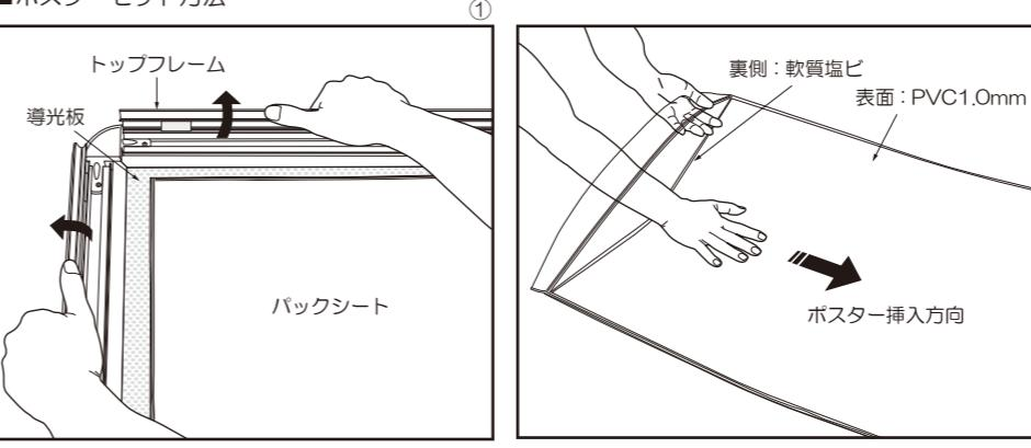
フレームを4辺手で開きます。防水電飾用パックシートがセットされているので外します。開閉時に指を挟まない様にお気をつけ下さい。
