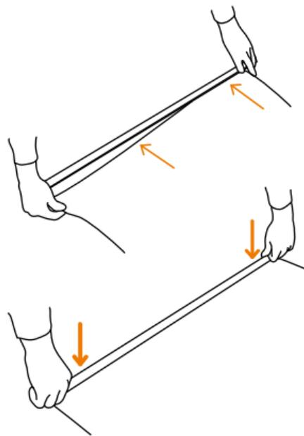
2. メディアを上に向けて画像をマウントします。ジョイントシートの粘着テープに貼り付けます。メディアの位置を「ガイドライン」に合わせてください。
