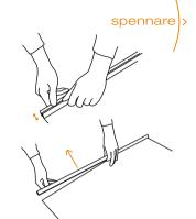
4. 上部のプロファイルを慎重に開いてメディアを取り外します。 プロファイルを開くのが難しい場合は、コインなどを使用してください。
