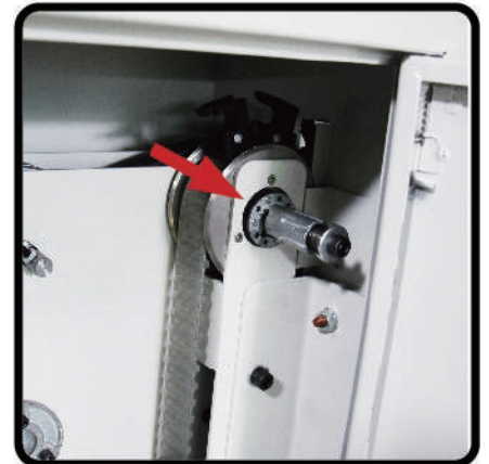
3. ロックが解除され、フックベルトを手動で動かすことが可能となります。
