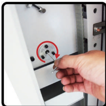
5. コインメック背面のねじを締めます。
