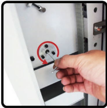
1. コインメック背面のねじを外します。
